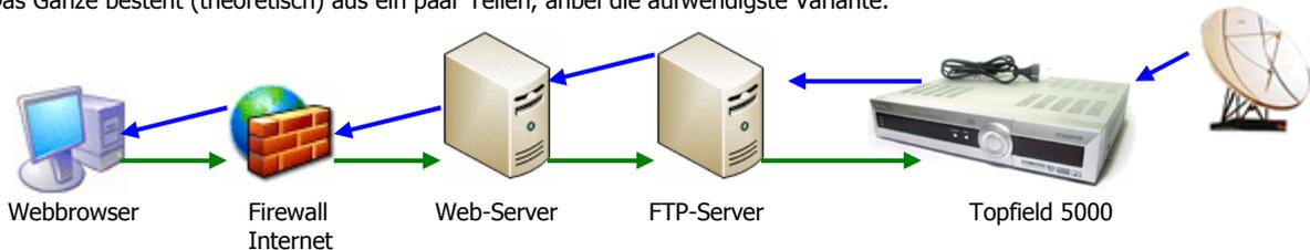
**Blauer Weg:** Via Sat empfängt der Topf das EPG sowie die verschiedenen Sender. Aus dieser Info erstellt Jag's EPG eine Text/HTML-Datei und legt sie am Topf ab. Aldarin's FTP Server stellt dem Webserver eine Schnittstelle zum Topf zu Verfügung, wodurch sich der Webserver die Sender und das EPG holen kann. Der Webserver stellt nun diese Infos via http (HTML, ASP, Frames) bereit, sie können von jedem Browser abgerufen werden.
